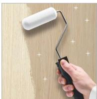
Przed użyciem dokładnie wymieszaj. Następnie za pomocą pędzla lub wałka do lakierów nałóż warstwę farby - zgodnie ze słojami drewna. Unikaj powstawania zgrubień i zacieków. Na lekko przeschniętą powierzchnię po ok. 5 min nałóż drugą warstwę w ten sam sposób. Powierzchnie szczególnie narażone na ścieranie zalecamy pokryć trzecią warstwą produktu. Nie nakładaj na powierzchnie laminowane i z melaminy. Przed użytkowaniem powierzchnię pozostaw do wyschnięcia na minimum 24 godziny.
